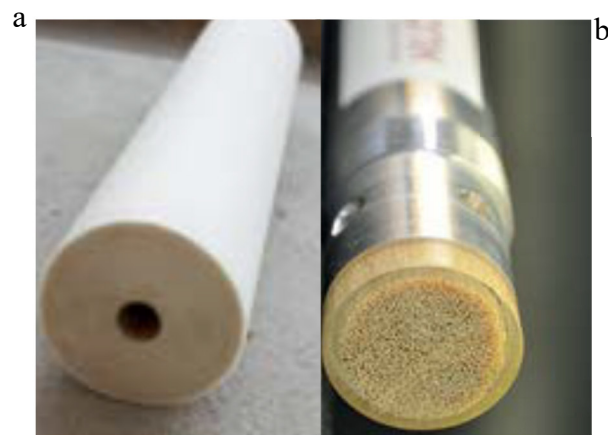
Figura 1: Membrana: a) Flatsheet membranes empilhada; b) Hollow fibre membranes dentro de um módulo (para purificação de gás). [3]
