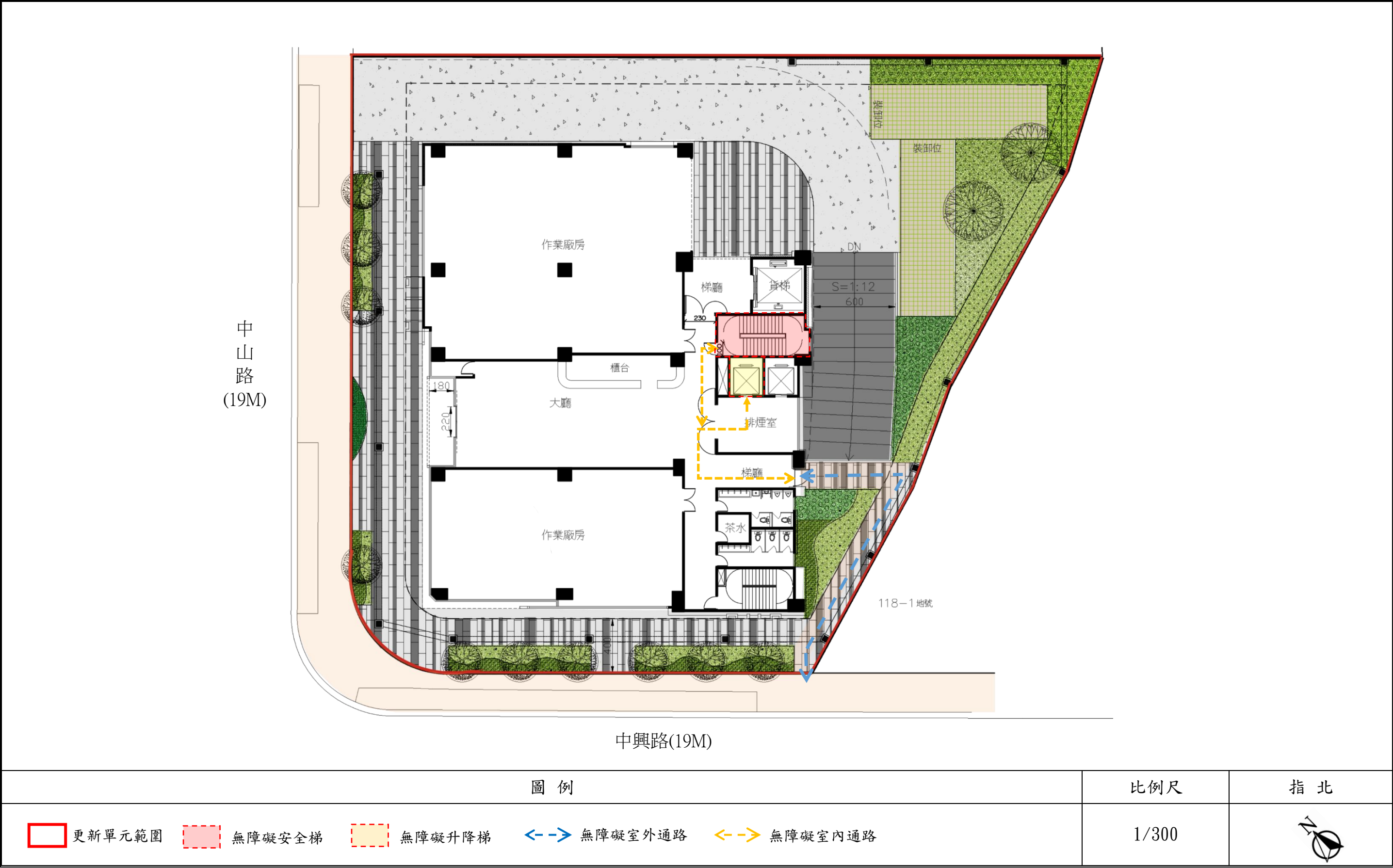
圖12-11 無障礙空間引導設施系統示意圖
