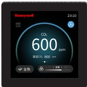
AI 智控三合一偵測器內置 PM2.5、CO<sub>2</sub>、溫濕度偵測器，對環境進行即時監測；根據不同配置，支援接入除濕機、全熱交換機和清淨機中的一臺或多臺設備。
