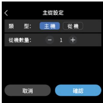
設定當前偵測器接入統 RS-485 硬體系統的主從模式：若設為主控制器，需設定接入的從機數量；若設為從機，需設定其在當前系統中的從機編號。
