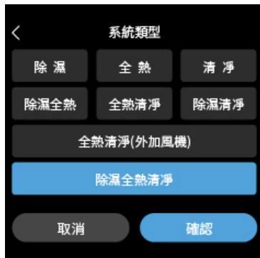
系統類型設定，用於配置當前偵測器需接入的被控功能設備或設備組合（僅主機可進行此設定）。
