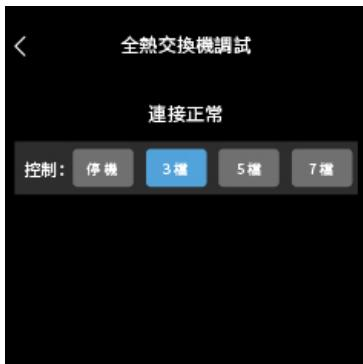
全熱交換機調試用於對接入偵測器的全熱交換機之通訊功能及基本運行控制進行調試（僅主機可進行此調試）。
