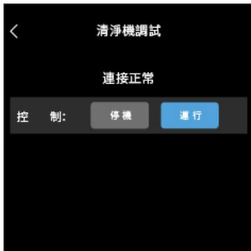
清淨機調試用於對接入偵測器的清淨機通信功能及基本運行控制進行調試（僅主機可進行此調試）。
