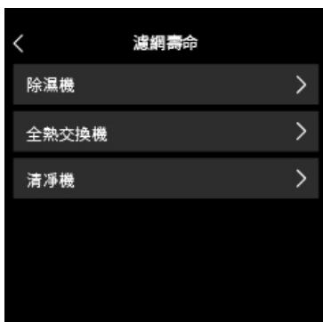
濾網壽命設定，用於對接入系統的除濕機、清淨機、全熱交換機內的濾網壽命進行初始化設定（僅主機可進行此設定）。
