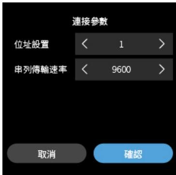
連接參數設定，用於配置當前 RS-485 系統設備的位址設定及串列傳輸速率(僅主機可進行此設定)。
