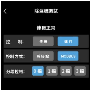
除濕機調試用於對接入偵測器的除濕機控制方式、通信功能及基本運行控制進行調試（僅主機可進行此調試）。
