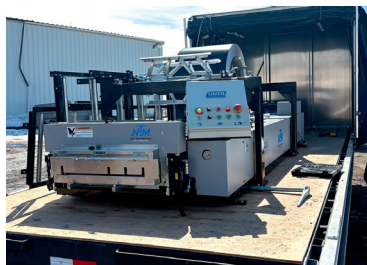
Vue de la machine mobile de profilage de tôle qui se déplace sur les chantiers.
