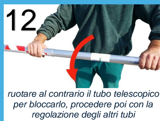
La regolazione dell'altezza del tunnel pedonale avviene tramite lo sfilo dei tubi telescopici che si possono regolare nella posizione come in figura o sollevato
