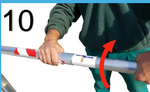
tourner le tuyau télescopique pour le déblocage comme indiqué sur l'étiquette
