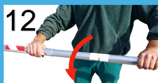
tourner en sens inverse le tuyau télescopique pour le bloquer, puis procéder avec le réglage des autres tuyaux
