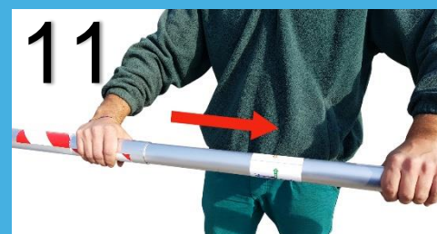
enlever le tuyau télescopique jusqu'à la longueur nécessaire. Un trou indique une référence standard de 2 mètres
