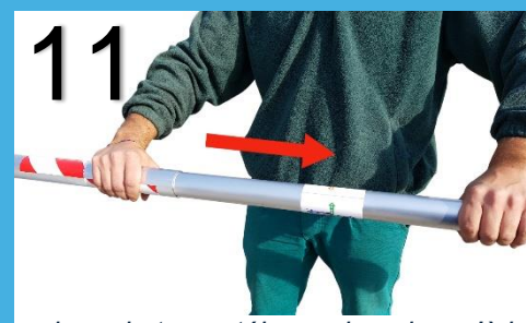
enlever le tuyau télescopique jusqu'à la longueur nécessaire. Un trou indique une référence standard de 2 mètres
