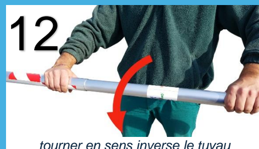
tourner en sens inverse le tuyau télescopique pour le bloquer, puis procéder avec le réglage des autres tuyaux
