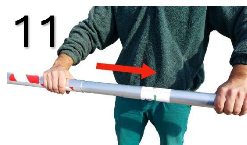
sfilare il tubo telescopico fino alla lunghezza necessaria. Un foro indica un riferimento standard a 2 metri
