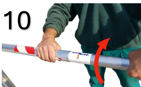
ruotare il tubo telescopico per lo sblocco come indicato su etichetta
