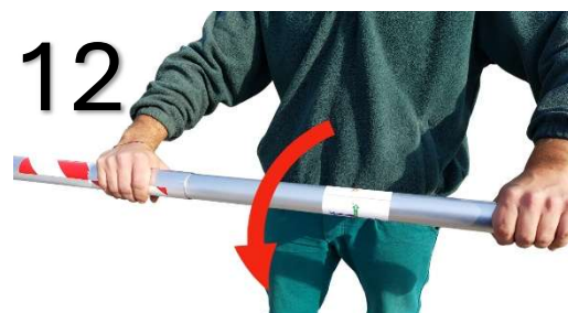
ruotare al contrario il tubo telescopico per bloccarlo, procedere poi con la regolazione degli altri tubi
