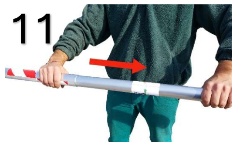
sfilare il tubo telescopico fino alla lunghezza necessaria.
