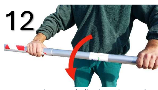
ruotare al contrario il tubo telescopico per bloccarlo, procedere poi con la regolazione degli altri tubi
