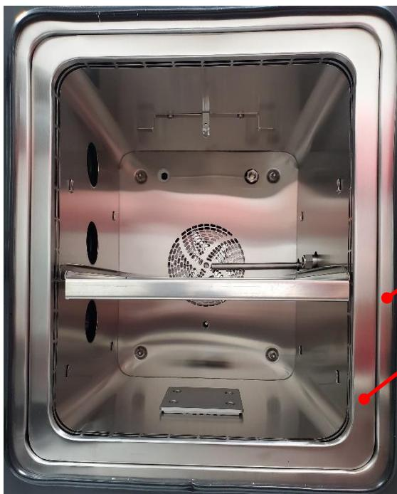
garantiert perfekte Dichtheit. Der integrierte Kammerlüfter sorgt für die interne Luftzirkulation, um eine hohe Homogenität und Stabilität im gesamten Arbeitsvolumen zu gewährleisten.
