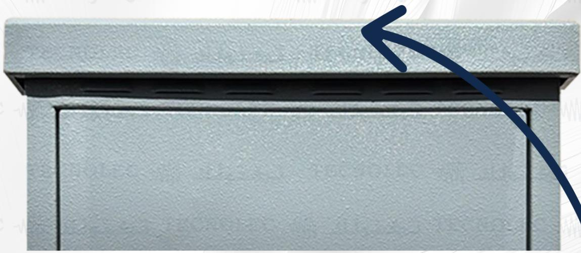
**Le chapeau posé sur l'armoire est conçu pour protéger de la pluie, du soleil, du froid et de la chaleur. Il est également démontable de l'intérieur de la cabine pour permettre l'intervention sur les ventilateurs d'extraction d'air, Situés a l'intérieur du chapeau.**
