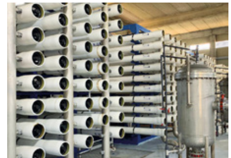
Recambio parcial de membranas estándar por Nano H_2O (ex LG-Chem) de alta eficiencia para osmosis inversa.
