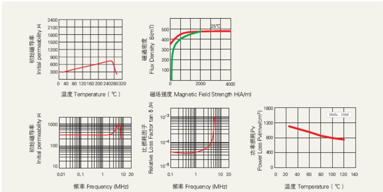
注：以上数据是根据标准样环  $\varnothing 25 \times \varnothing 15 \times 8$  获得的典型数据，有关产品的具体性能会在此基础上有所调整。
