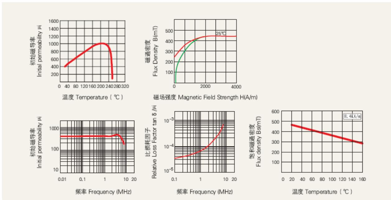
注：以上数据是根据标准样环  $\varnothing 25 \times \varnothing 15 \times 8$  获得的典型数据，有关产品的具体性能会在此基础上有所调整。
