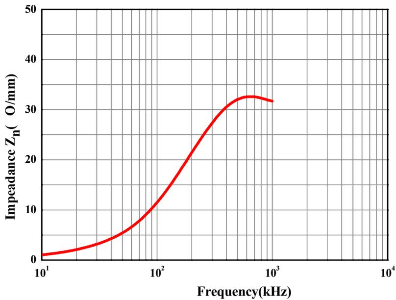
以上数据是根据标准样环  $\phi 25 \times \phi 15 \times 8$  获得的典型数据，有关产品的具体性能会在此基础上有所调整。
