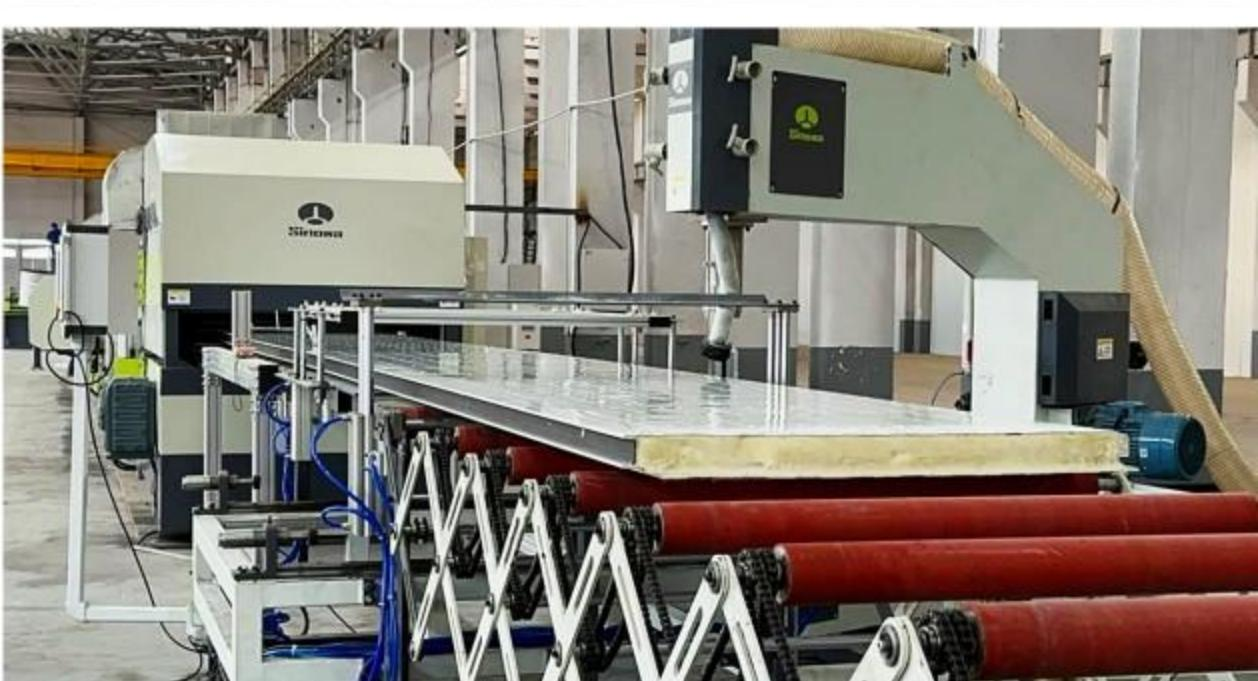
Sinowa 研发的高端保温板生产线为您提供高效的产业价值，我们的生产效率至少是同类产品的2倍以上，拥有国内外产品中最高的超性价比。此条生产线能生产多品种多规格的保温夹芯板，包括聚氨酯夹芯板、岩棉夹芯板(聚氨酯封边)，主要用于屋面夹芯板、墙面夹芯板和冷库板，厚度和宽度均可在设定范围内调整。
