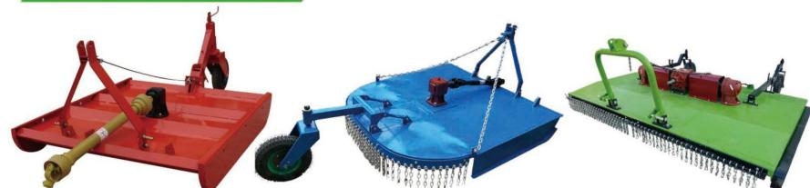
本薯收获机可以适用于多种9GX系列旋转割草机主要适用于草场、灌木林地的割草、清理以及地表不平整牧场的更新、改造等作业。该系列割草机利用偏置式曲柄连杆机构驱动割刀进行割草作业。
