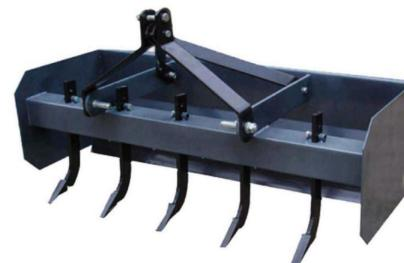
箱刀平地机是一种利用刮刀平整地面的农用机械。动作灵活准确，操纵方便，平整场地有较高的精度，适用于构筑路基和路面、修筑边坡、开挖边沟，也可搅拌路面混合料、扫除积雪、推送散粒物料以及进行土路和碎石路的养护工作。宽度：4-7英尺。
