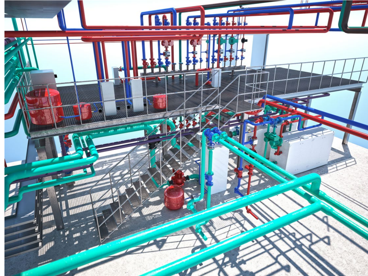
Auszug BIM-Modell KA-LEV Abwasserwärmepumpen
