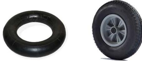
Viele Dino Cars GoKarts sind mit schlauchlosen und mit Luft gefüllten Rädern – wie bei einem PKW - ausgestattet. Diese Räder bieten optimale Fahr- und Komforteigenschaften. Es kann vorkommen – gleichfalls wie beim PKW, dass die Räder z. B. durch spitze Gegenstände im Mantel, Luft verlieren oder ganz platt sind. In diesen Fällen empfiehlt es sich einen Schlauch in das Rad einzuziehen. Die nachfolgende Anleitung beschreibt, wie Sie ohne großen Aufwand einen Schlauch montieren können.
