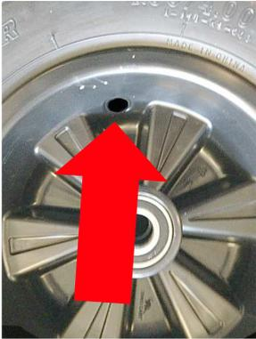
Nach Entfernung des Ventils ist nur die Bohrung in der Felge zu sehen (4).
