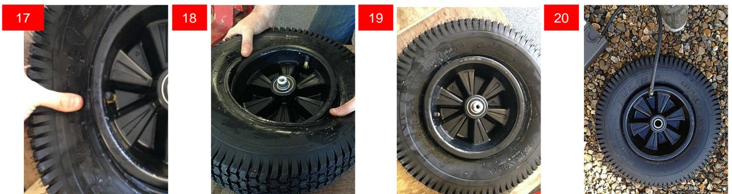
Wenn der Schlauch eingesetzt ist (17), drücken Sie den Mantel wieder in die Mitte der Felge (18). Drehen und drücken Sie den Mantel im Kreis, bis der Mantel wieder auf der Felge sitzt (19). Pumpen Sie den Reifen mit einen Kompressor oder Luftpumpe auf (20). Der Reifendruck beträgt im Regelfall 1,8 bar/26 psi. Bitte Reifendruckangaben auf Felge und Mantel beachten. Es gilt der niedrigere Druck.
