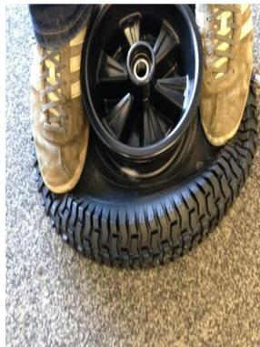
Stellen Sie sich auf den Mantel (5) und wechseln Sie die Standposition solange bis Sie ein „Plop-Geräusch“ hören und sich der Reifen von der Felge löst (6).
