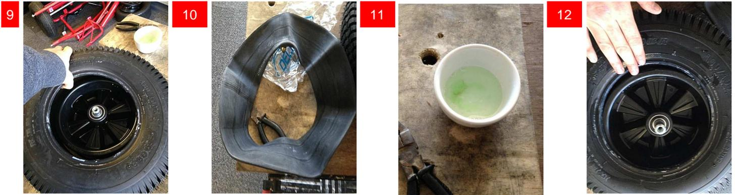
Jetzt können Sie den Schlauch (10) einsetzen. Reiben Sie den Mantel (12) und den Schlauch (10) mit einer Mischung aus Spülmittel (11) und Wasser ein, um ein gute Gleitfähigkeit bei der Montage zu erhalten.
