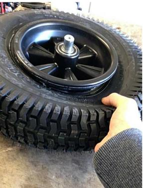
Drücken Sie den Mantel auf der einen Seite des Rades mittig zusammen (7). Wenn Sie den Mantel zusammengedrückt haben, werden Sie feststellen, dass zwischen dem Mantel und der Felge auf der anderen Seite des Rades ein kleiner Spalt entsteht.
