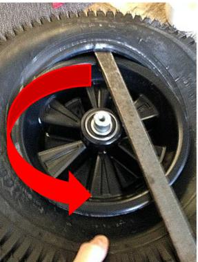
Verwenden Sie entweder einen Reifenheber, ein Montiereisen oder einen Schlitzschraubendreher (8). Schieben Sie das Werkzeug in den Spalt und drehen Sie das Rad in Pfeilrichtung, während Sie das Werkzeug in der angegebenen Position halten.
