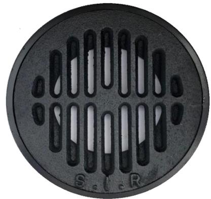
Coladera de hierro fundido de 20 cm de diámetro total para bajada de agua de 10 cm (4 pul), con brocal de hierro fundido Área de captación 315 cm<sup>2</sup>
