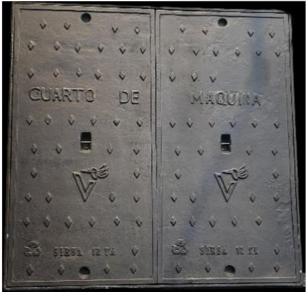
Tapadera 1.50 x 1.50 metros con brocal en 2 secciones de hierro fundido, soporte de peso 12 toneladas con brocal de acero al carbono y jaladores en el centro para el izado.
