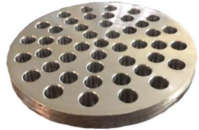
Coladera de ALUMINIO de 13 cm de diámetro total para bajada de tubo de 10 cm con brocal. Velocidad de evacuación 1 m<sup>3</sup> en 6 minutos. Libre de mantenimiento.
