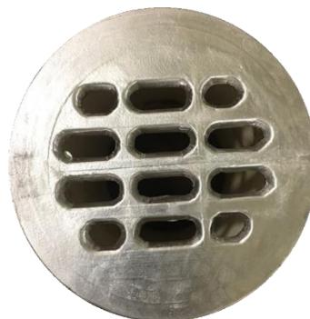
Coladera en hierro fundido de 13 cm de diámetro total para bajada de tubo de 10 cm con brocal. Velocidad de evacuación 1 m<sup>3</sup> en 6 minutos. Área de captación 133 cm<sup>2</sup>
