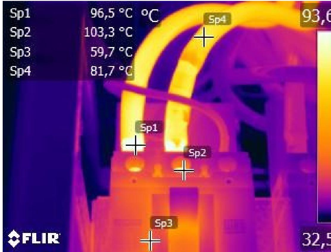
É uma Técnica de inspeção preditiva não destrutiva, que baseia-se na medição de temperatura por meio de irradiação infravermelho. O objetivo da Termografia é identificar desvios térmicos (aquecimento) em componentes e contatos elétricos, propondo ações antes de sua falha.
