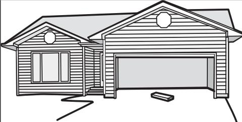
Appuyez sur le bouton poussoir de la télécommande pour fermer la porte. La porte DOIT s'inverser lorsqu'elle entre en contact avec la planche.
