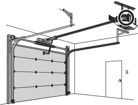
Votre ouvre-porte de garage est conçu avec des commandes électroniques pour faciliter la configuration et les réglages. Les réglages vous permettent de programmer l'endroit où la porte s'arrêtera en position ouverte (HAUTE) et fermée (BASSE).
