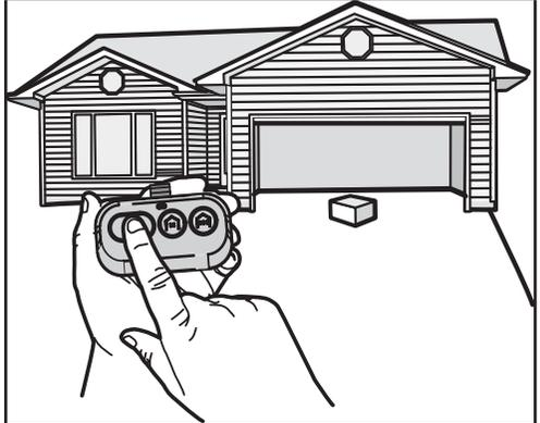
L'ouvre-porte de garage ne se fermera pas à partir d'une télécommande si la DEL de l'un ou l'autre des capteurs clignote (ce qui vous avertit du fait que le capteur est mal aligné ou obstrué).
