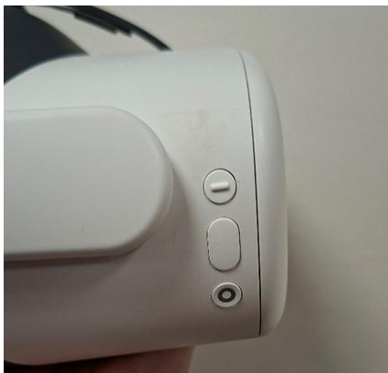
3 knoppen op de rechterzijde van de headset
