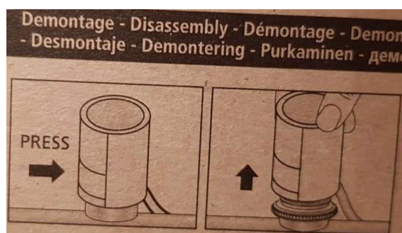
Bilde 2: Demontering av aktuator
