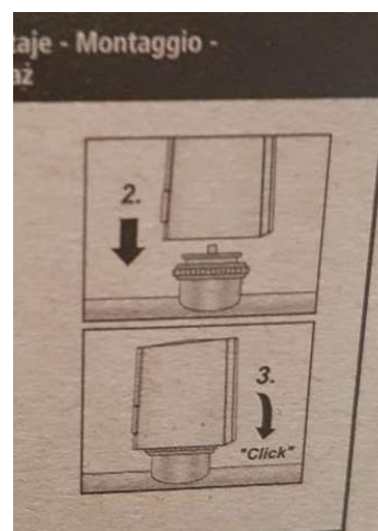
Bilde 3: Montering av aktuator
