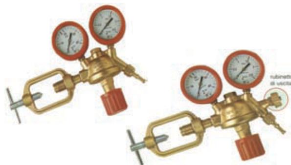
Riduttore di pressione per acetilene in ottone stampato OT58 norma EN-ISO 2503, con valvola per sovrappressione e due manometri a norma EN562
