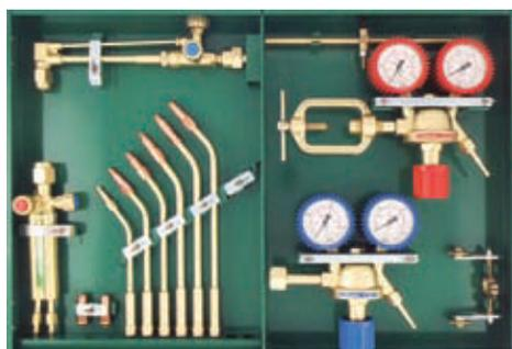
6 o 8 lance, dispositivo di taglio, 2 punte da taglio, riduttore per ossigeno e acetilene, carrello guida e compasso.
