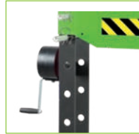
ARGANO A FUNE PER REGOLARE ALTEZZA PIANO DI LAVORO
