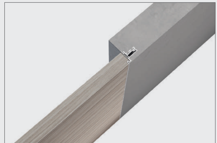
PARTICOLARE DEL TELAIO IN ALLUMINIO
