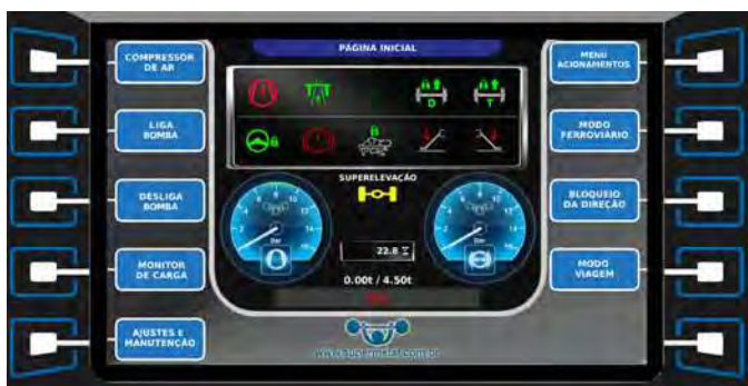
Representação do Painel da IHM (Interface Homem-Máquina) da cabine do veículo
