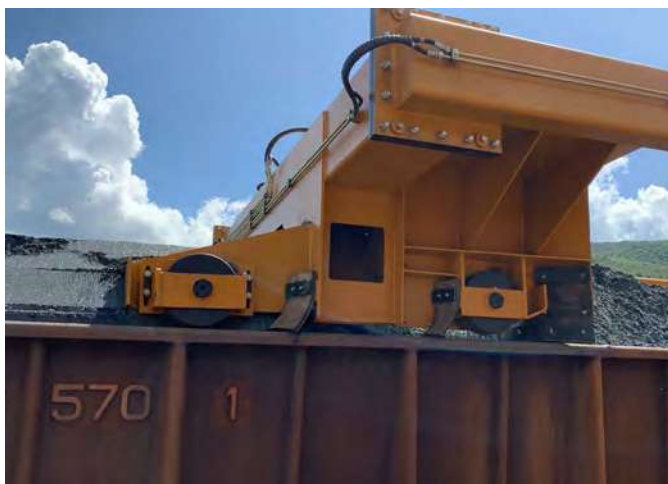
Formatador de Carga em atuação, com as rodas-guia direcionando o equipamento sobre os vagões
