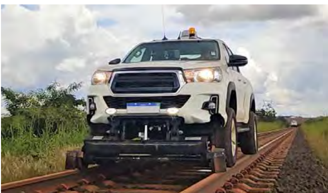
Visão da dianteira do veículo, indicando a posição de descanso do Kit Dianteiro
