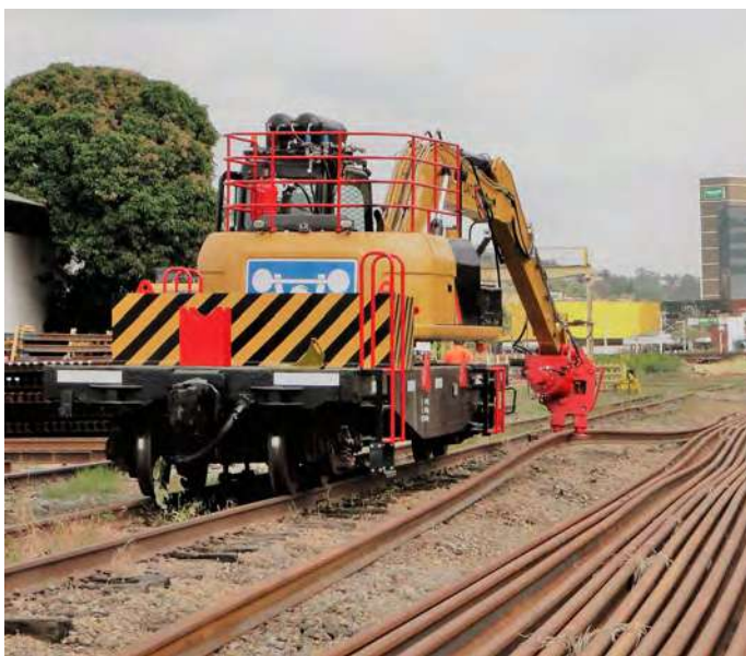
Movimentação e ajustes de trilhos com garra roletada
