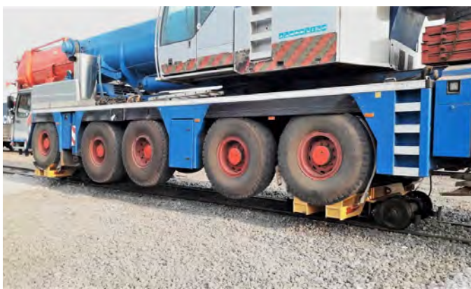
Visão lateral do veículo já sobre os troles
