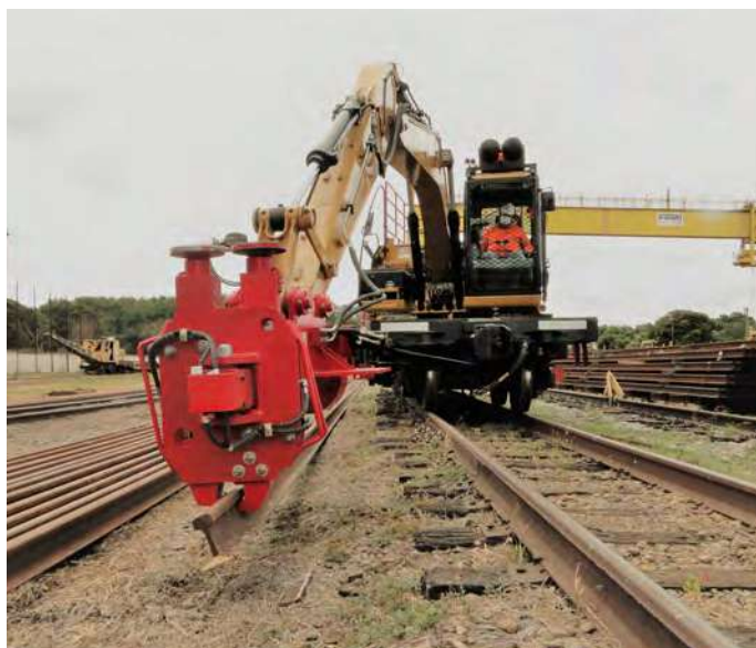
DATLS ajustando a garra de mordentes sobre o trilho
