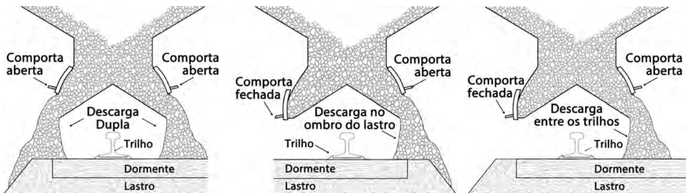
Todas as possibilidades para descarga de trilho. Em ambos os lados da comporta, somente no ombro do lastro ou somente entre os trilhos, conforme necessidade.
