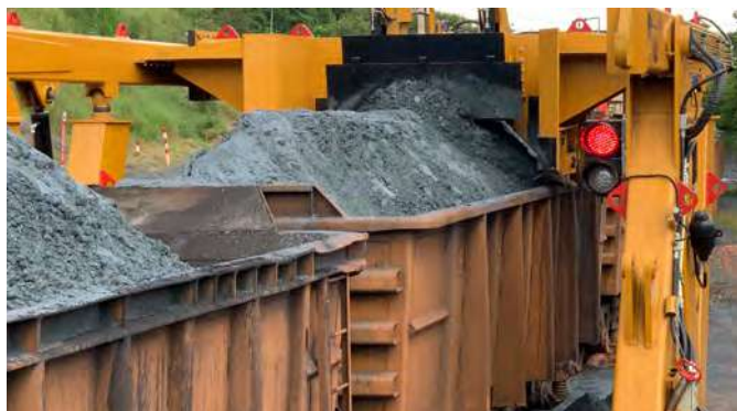
Semáforo de Segurança, indicando que o Formatador de Cargas está com o braço abaixado
