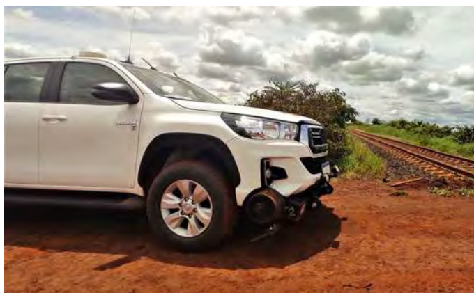
Visão lateral do veículo, mostrando como o Kit Ferroviário fica contido sob a estrutura
