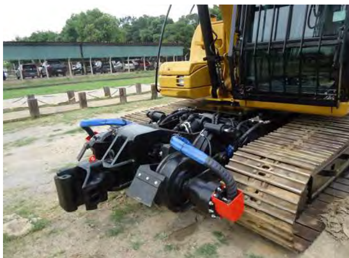
Detalhe do Engate Ferroviário compatível com a Escavadeira Rodoferroviária
