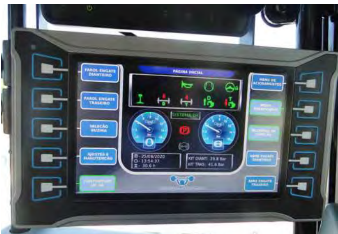
Aspecto parcial da vista do monitor IHM para o operador de dentro da cabine
