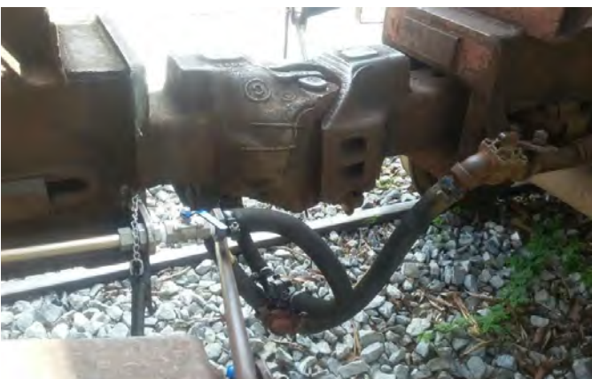
Demonstração de vagões com circuitos de ar comprimido adicionais, alimentando os cilindros das comportas
