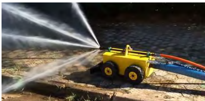
Robô autopropulsado para limpeza de bueiros de grande extensão
