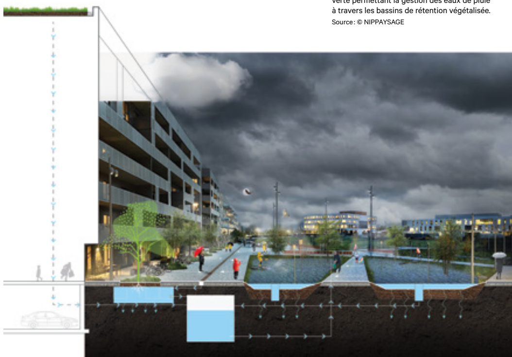
Illustration du fonctionnement de l'infrastructure verte permettant la gestion des eaux de pluie à travers les bassins de rétention végétalisée.
