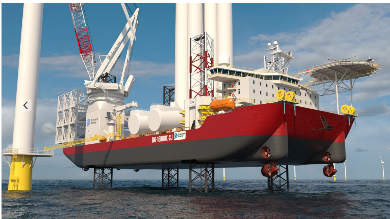
3Figur 4-6. Exempel på installationsfartyg för havsbaserad vindkraft. Byggskedet kan omfatta undersökningsfartyg, jack-up-fartyg, heavy lift-fartyg, kabellägningsfartyg, servicefartyg och bogser-/ankarfartyg. Foto/illustration: Salt Offshore AB/Newera Energy AB, 2026.
