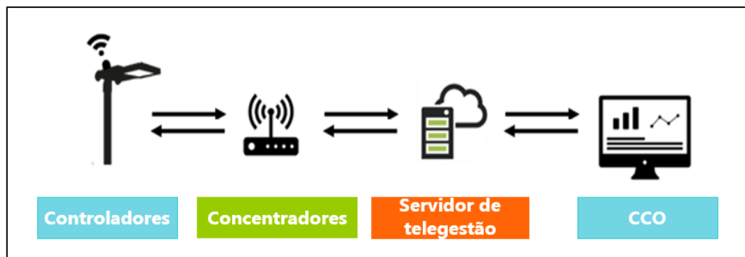
Figura 27 - Estrutura operacional do Sistema de Telegestão
