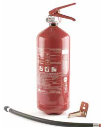
23849 ESTINTORE A POLVERE DA KG. 6 Classe di fuoco: 34A - 233B - C Carica nominale: 6 kg Estringente: ABC MAP 20% Peso totale: 9,5 Kg Diametro serbatoio: 160 mm Altezza: 510 mm Temp. di esercizio: -30° C / + 60° C Valvola: Plastica Supporto: Non incluso
