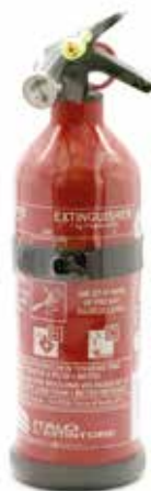
23848 ESTINTORE A POLVERE DA KG. 2 Classe di fuoco: 13A - 89B - C Carica nominale: 2 kg Estringente: ABC MAP 20% Peso totale: 3,7 Kg Diametro serbatoio: 110 mm Altezza: 380 mm Temp. di esercizio: -30° C / + 60° C Valvola: Plastica Supporto: Incluso
