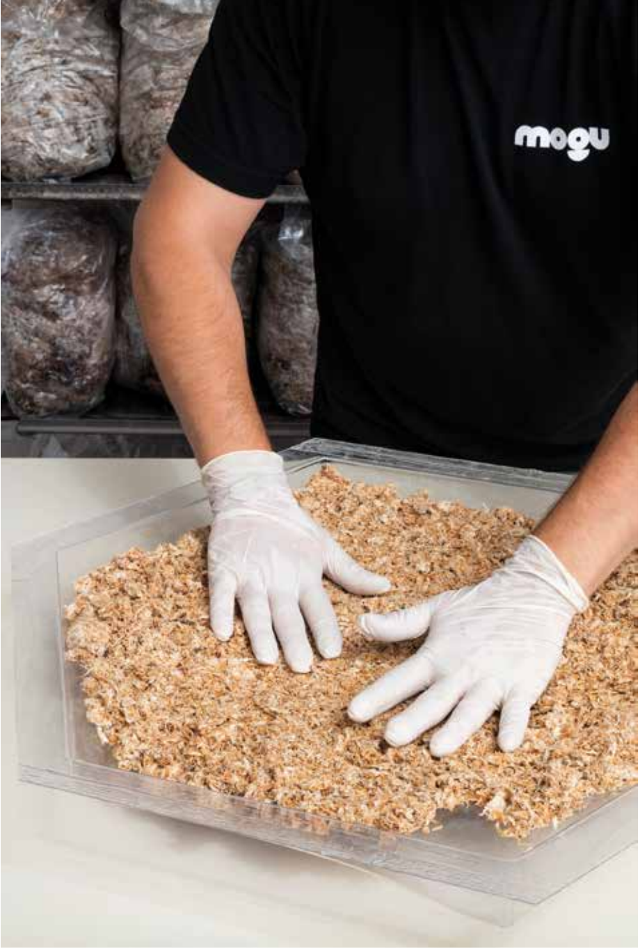
■ Dal micelio cresciuto su scarti naturali alla struttura solida del pannello, Pluma nasce da un processo di bio-fabbricazione che unisce innovazione, sostenibilità e performance certificate.
