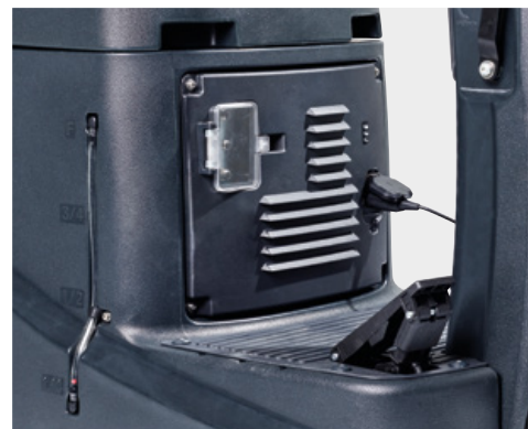
Caricabatteria a bordo che consente una facile ricarica della batteria in qualsiasi presa di corrente
