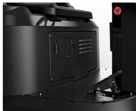
Scatola portafusibili con punto di ricarica esterno
