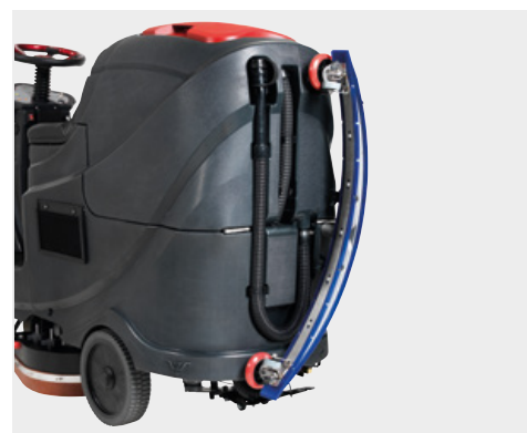
Tergi agganciabile al serbatoio di recupero per consentire alla macchina di passare nelle aree più strette
