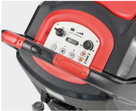
Gancio per il cavo sulla macchina
