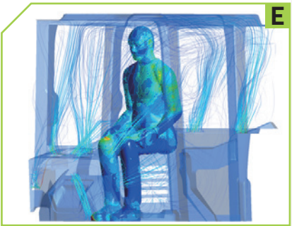
La cabina è sigillata ermeticamente con una pressione di +50 Pa e dotata di elementi filtranti di classe N95, con un'efficienza di filtrazione del PM2,5 \geq 99\%
