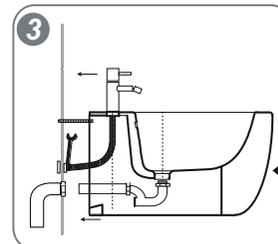
3 - Montare il rubinetto ed il sifone. (ATTENZIONE: il tubo di scarico deve uscire dalla ceramica la misura necessaria per poter essere connesso alla parete). Avvicinare il bidet alla parete e collega re flessibili del rubinetto ed il sifone.
