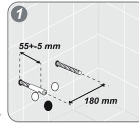
1 - Preparare gli scarichi e le viti di fissaggio secondo le misure riportate nello schema fianco (disegno 1), tagliare le barre se necessario.
