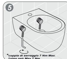
5 - Fissare il bidet mediante i perni di fissaggio. Si consiglia di avvitare alternativamente i dadi in modo da ottenere un serraggio migliore del bidet alla parete.
