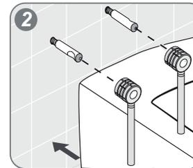
2 - Avvitare i due cilindri d'acciaio nelle barre. Inserire il sistema di fissaggio nella ceramica (disegno 2).
