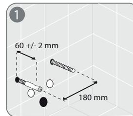
1 - Preparare gli scarichi e le viti di fissaggio secondo le misure riportate nello schema a fianco (disegno 1), tagliare le barre se necessario.
