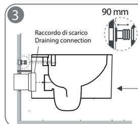
3 - Predisporre la connessione per lo scarico della cassetta e del vaso sospeso seguendo le indicazioni illustrate nel dettaglio ingrandito (ATTENZIONE: per facilitare le connessioni si consiglia di lubrificare entrambe le parti).
