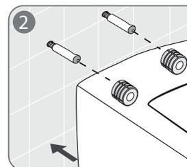
2 - Avvitare i due cilindri d'acciaio nelle barre. Inserire il sistema di fissaggio nella ceramica (disegno 2).
