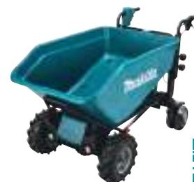
Capacità di carico 300 kg
