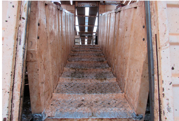
Rampa de acesso ao compartimento de carga com piso antiderrapante e laterais sólidas e resistentes.
