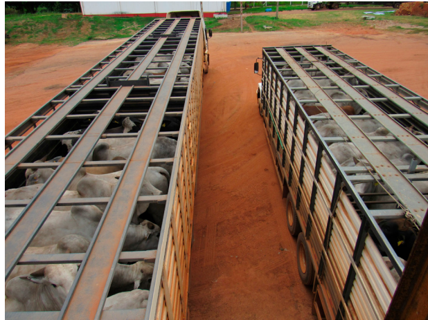
Tetos dos compartimentos de carga abertos, permitindo a circulação de ar, quando o veículo está em movimento.
