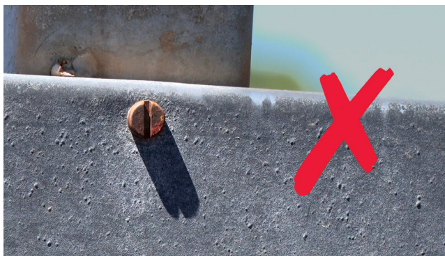
Superfície interna do compartimento de carga com parafuso proeminente.
