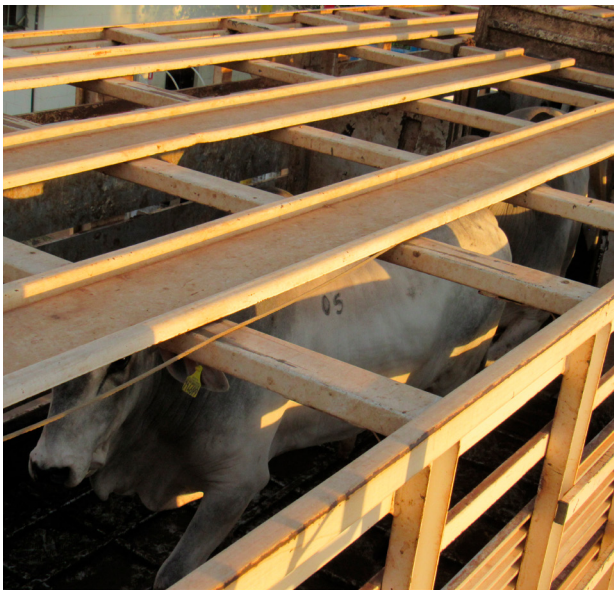
Barras transversais no teto do compartimento de carga.
