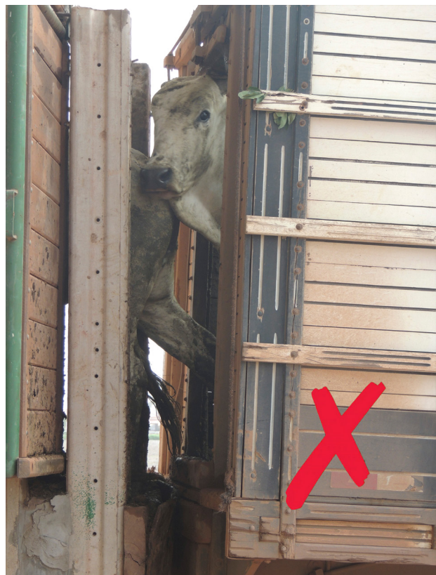
Veículo mal estacionado e desalinhado com a rampa de desembarque.
