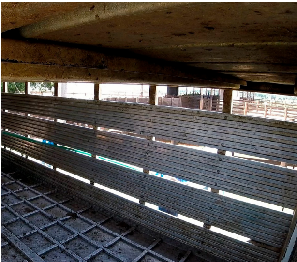
Parede lateral do compartimento de carga com frestas que permitem a circulação de ar, quando o veículo está em movimento.
