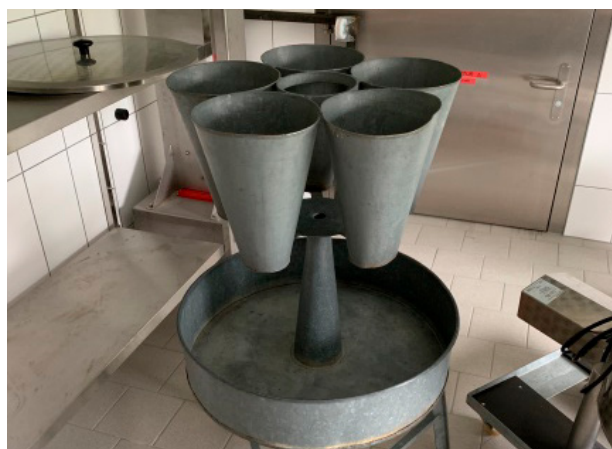
Estrutura de cones para contenção das aves.
