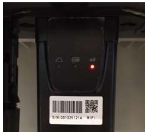
Figura 43 – Stato di comunicazione irregolare tra wifi e server remoto
