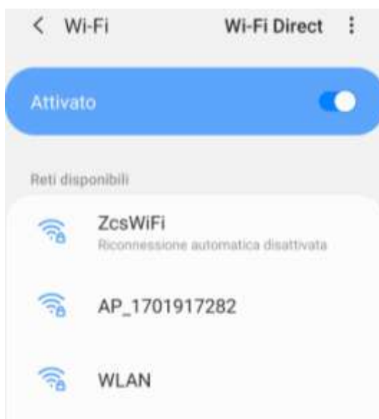
Figura 24 – Disattivazione della riconnessione automatica ad una rete
