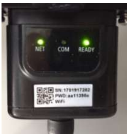
Figura 41 - Stato di comunicazione irregolare tra inverter e wifi
