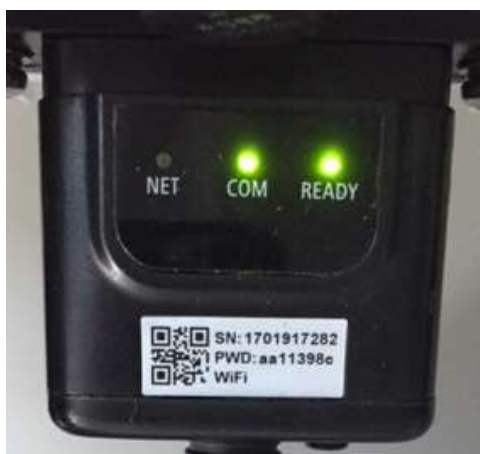
Figura 43 – Stato di comunicazione irregolare tra wifi e server remoto
