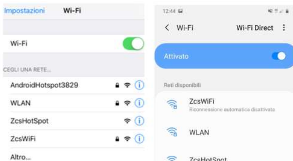
Figura 36 - Ricerca delle reti wifi su Smartphone (iOS e Android); l'Access Point della scheda wifi non è più visibile
