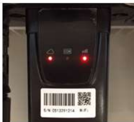
Figura 41 - Stato di comunicazione irregolare tra inverter e wifi
