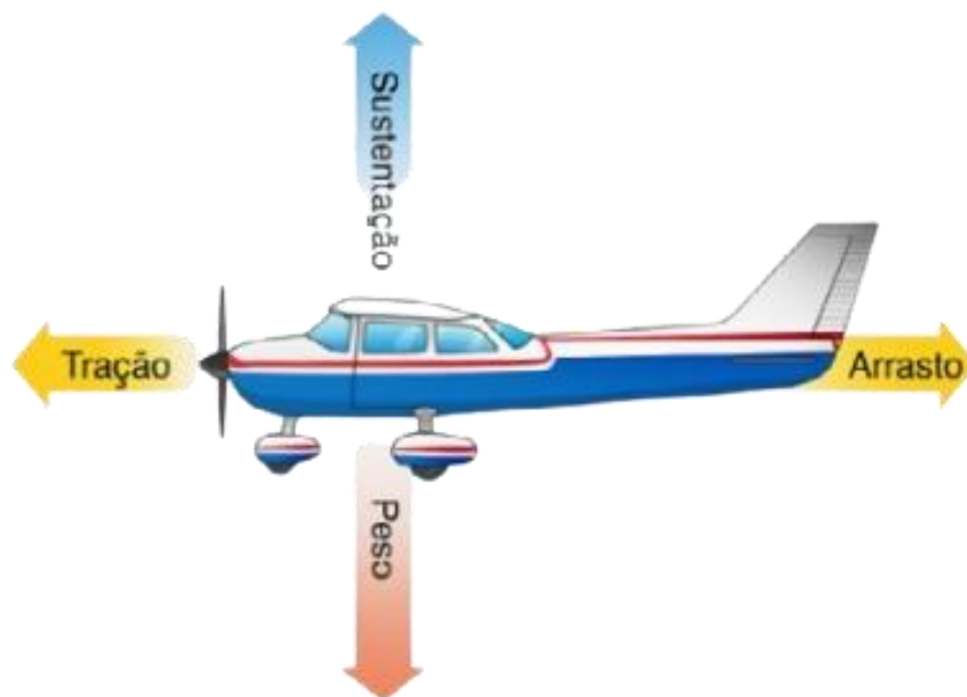
Figura 1 - Relação de forças atuantes em uma aeronave.
