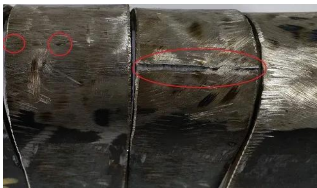
Figura 3 - Resultado de um ensaio de dobramento.
