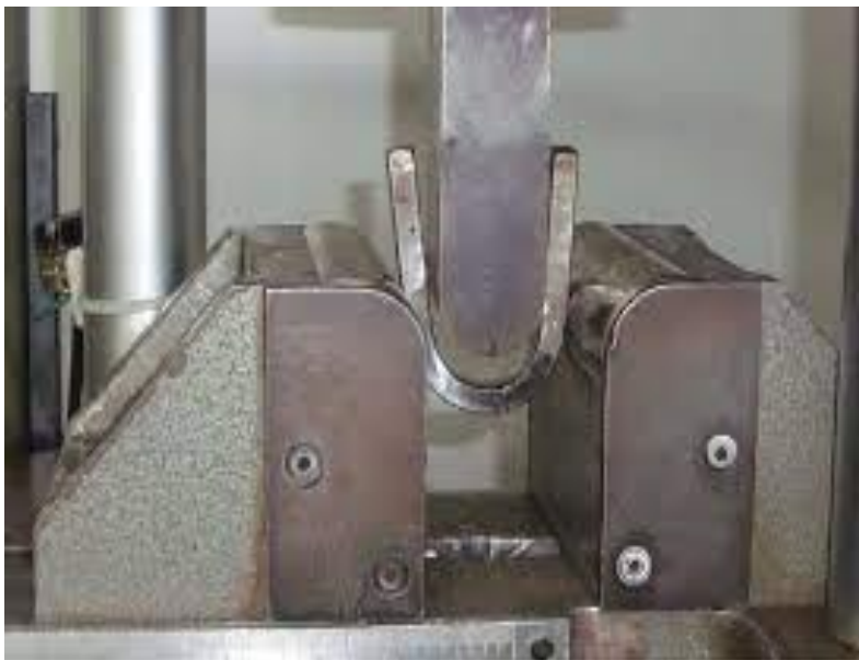
Figura 1 - Ensaio de dobramento em aço.
