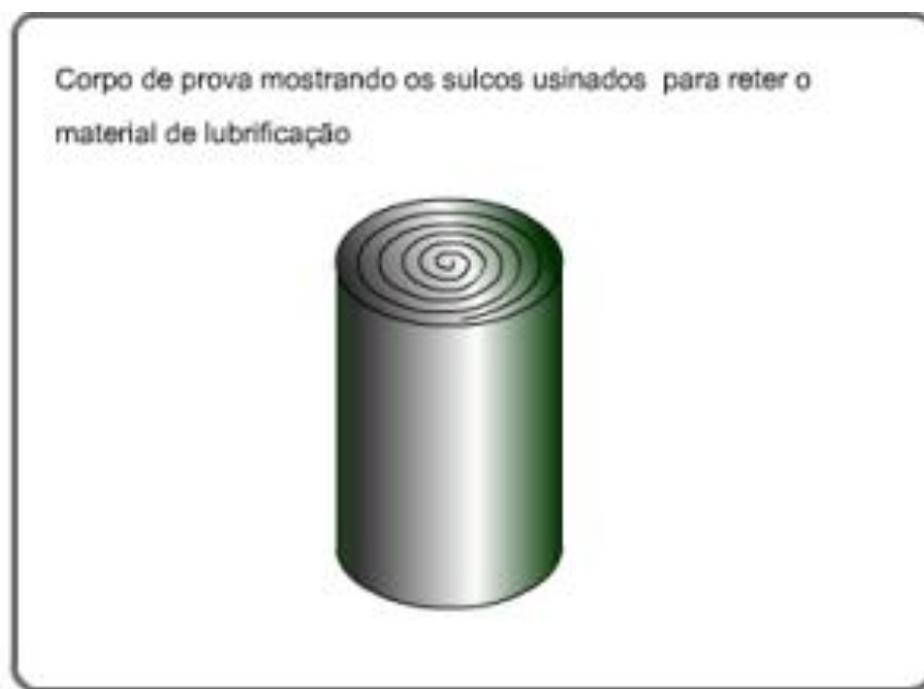
Figura 3 - Sulcos rasos usinados para lubrificação.
