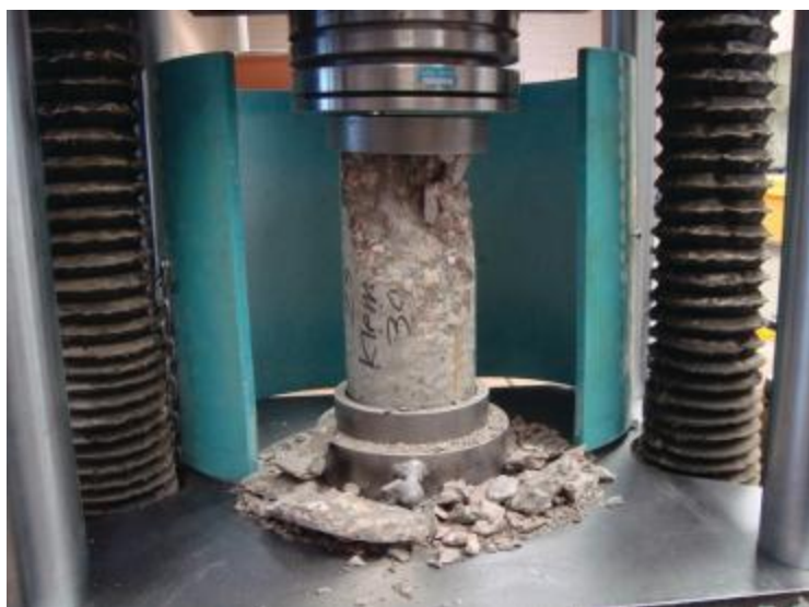
Figura 5 - Ensaio de compressão sendo realizado em um corpo de prova de concreto.
