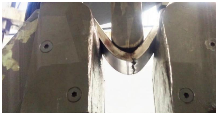
Figura 6 - Material submetido ao ensaio de dobramento
