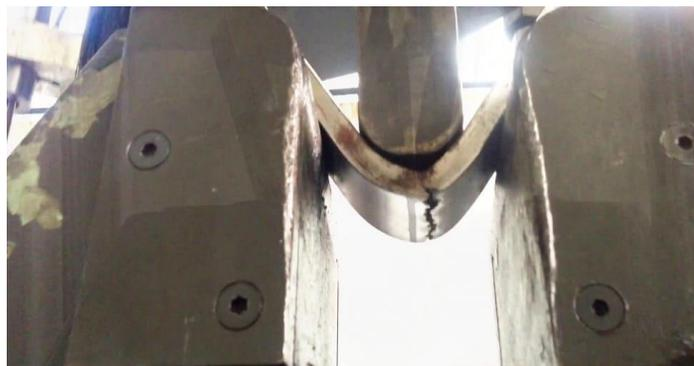
Figura 6 - Material submetido ao ensaio de dobramento
