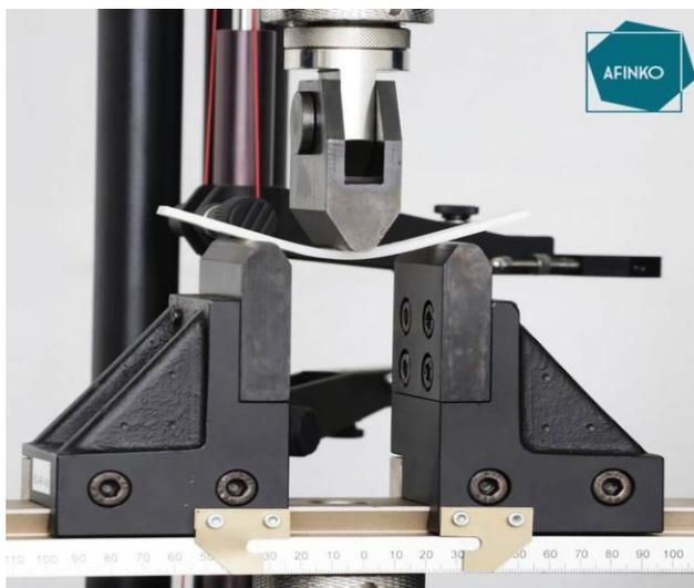
Figura 4 - Exemplo de ensaio de flexão
