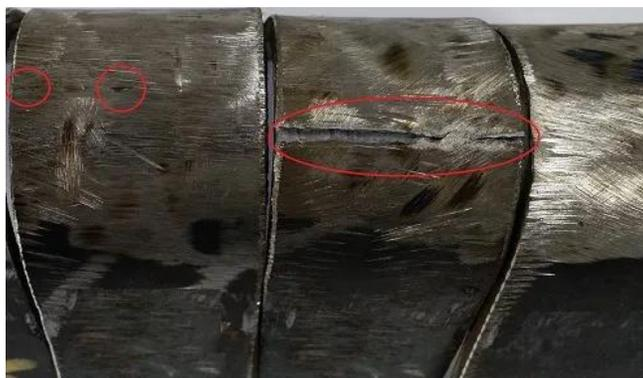
Figura 3 - Resultado de um ensaio de dobramento.
