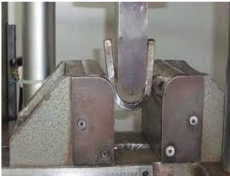
Figura 1 - Ensaio de dobramento em aço.
