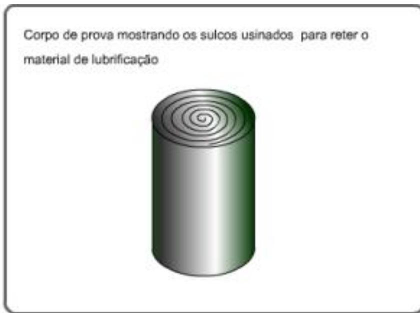
Figura 3 - Sulcos rasos usinados para lubrificação.
