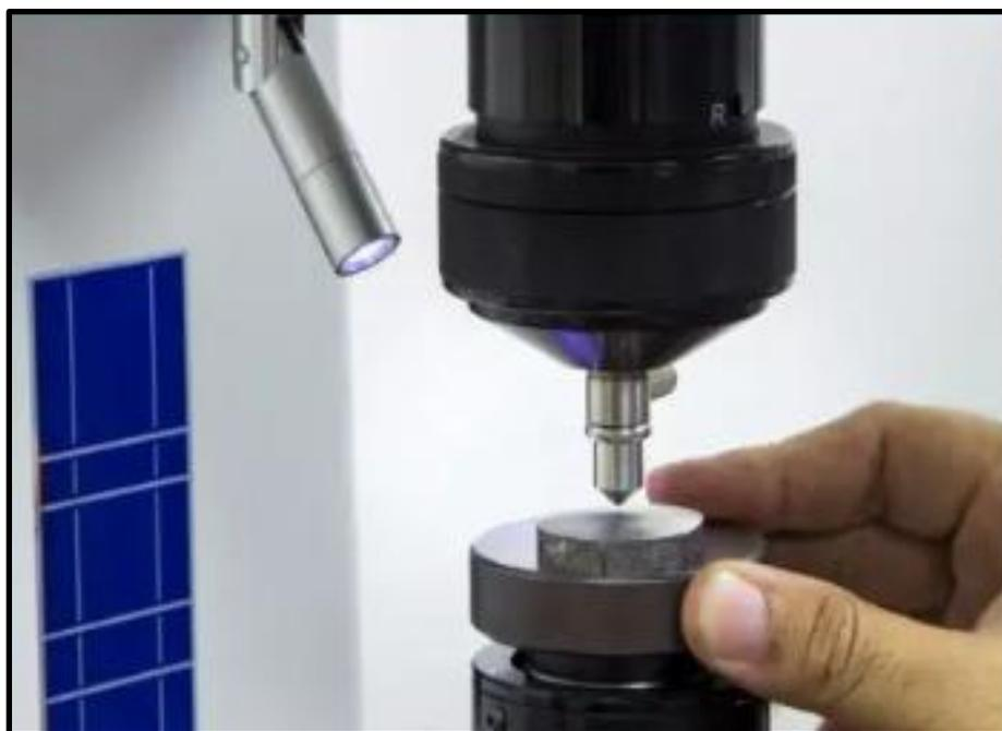
Figura 8 – Ensaio de Rockwell sendo aplicado.
