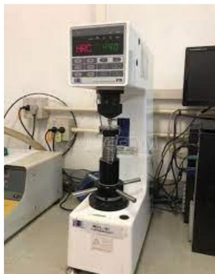
Figura 5 -Durômetro Rockwell Digital.
