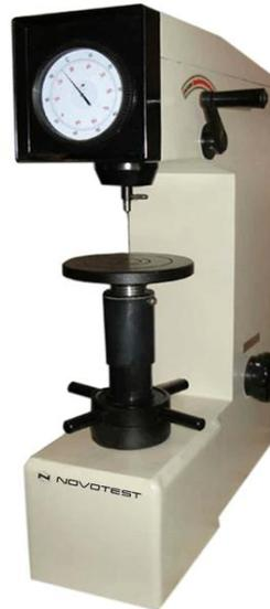
Figura 4 – Durômetro Rockwell.
