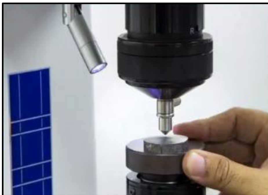
Figura 8 – Ensaio de Rockwell sendo aplicado.
