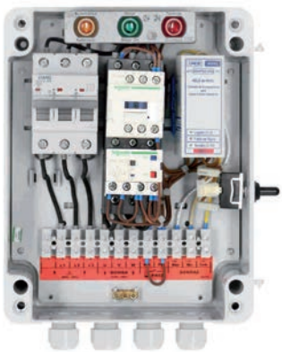
Cuadro eléctrico para BOMBA SUMERGIDA DE POZO de 1 sola bomba Protección de nivel de agua mediante sondas y control mediante un contacto (boya, presostato u otros)
