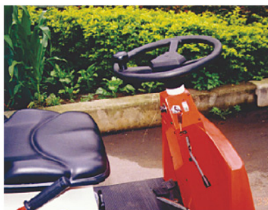
省力式動力方向盤，轉向操作輕巧
