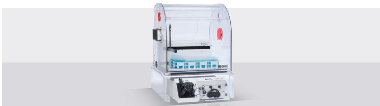
Analisi del Mercurio fino a 0,05 ng/l. Fluorescenza atomica a vapori freddi (CVAF), l'ideale per analizzare ultra-tracce di Mercurio, soddisfa i limiti di rilevamento richiesti dal metodo EPA 1631. L'M-8000 è anche sufficientemente versatile per analizzare campioni superiori a 400 mg/l senza diluizione.
