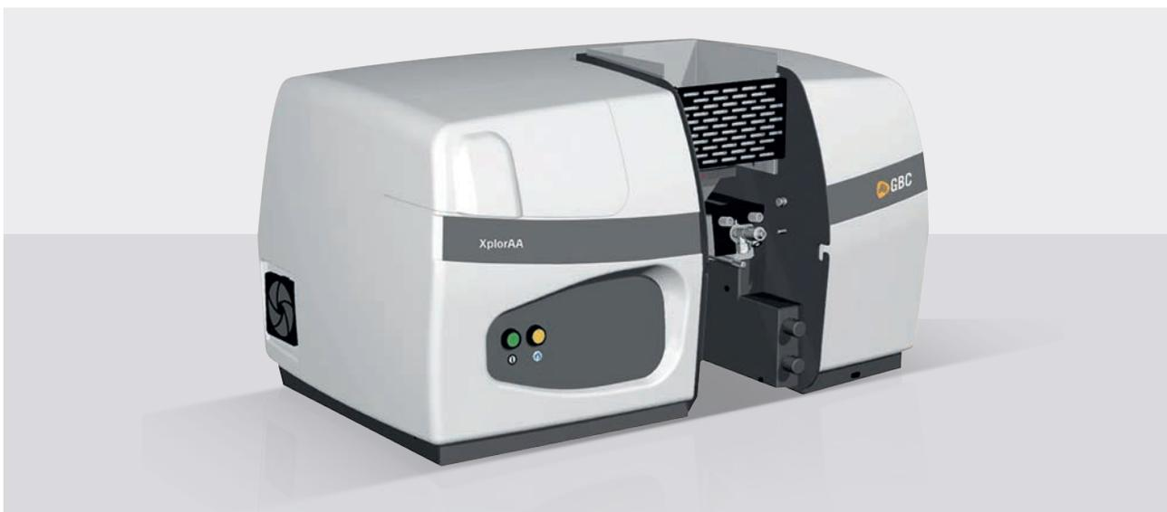
Le tecniche di analisi includono la lettura in fiamma, fornetto di grafite, kit degli idruri, configurazione DUETTO (Fiamma e fornetto con cambio automatico).
